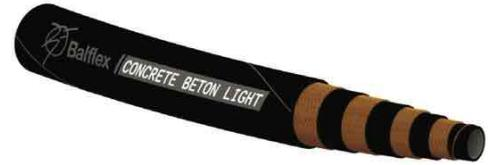
Presión de trabajo de 4.0MPa / 580PSI / 40bar/ Valor de pérdida por abrasión: Conforme a DIN 53516 < 65 mm<sup>3</sup> - 10.1246
